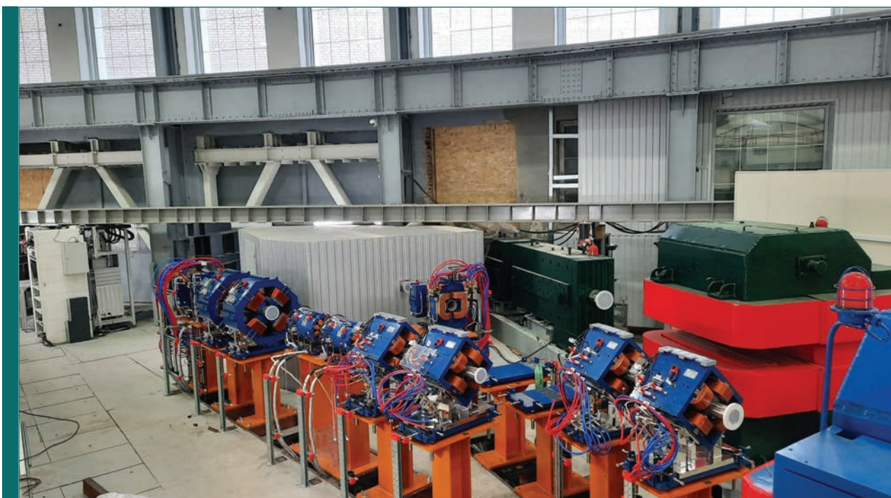
Лаборатория физики высоких энергий им. В. И. Векслера и А. М. Балдина. Каналы транспортировки пучков в зоне прикладных исследований на базе выведенных пучков ускорительного комплекса NICA
