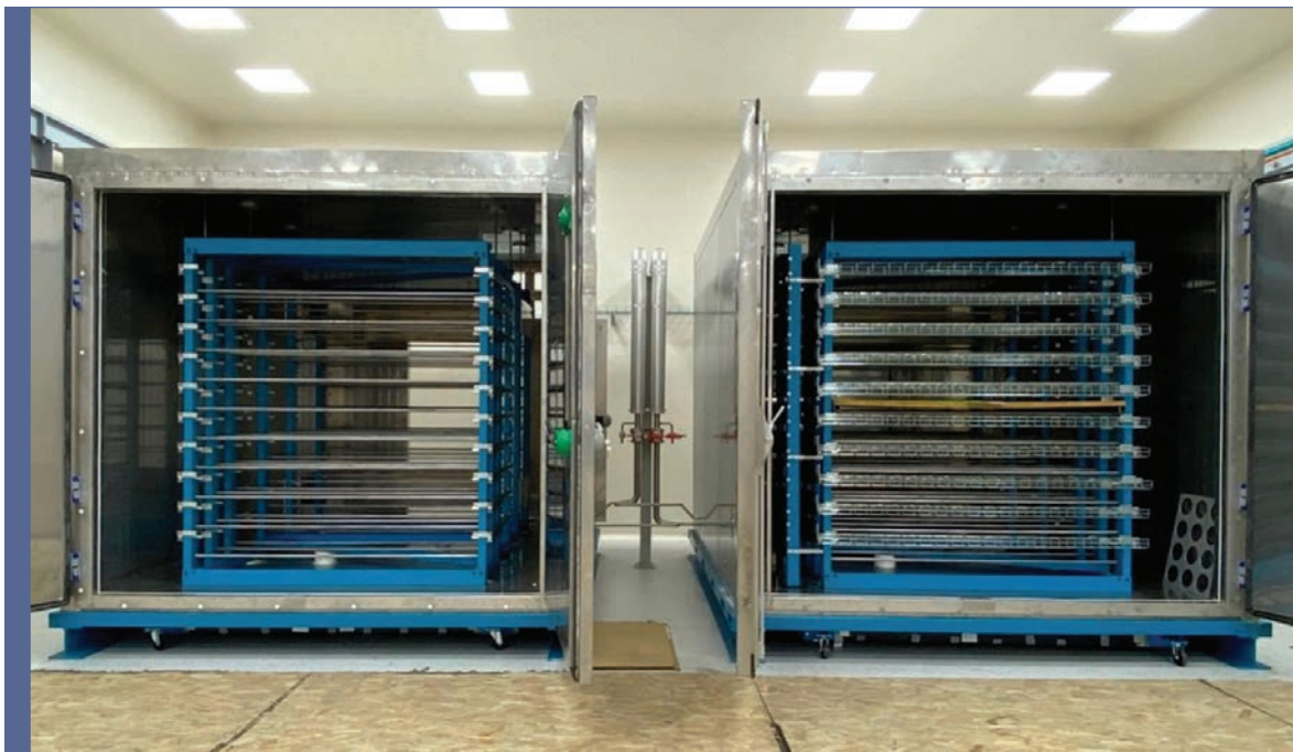
Теплоизолированные камеры стенда для проверки кассет калориметра высокой гранулярности HGCal, CMS
