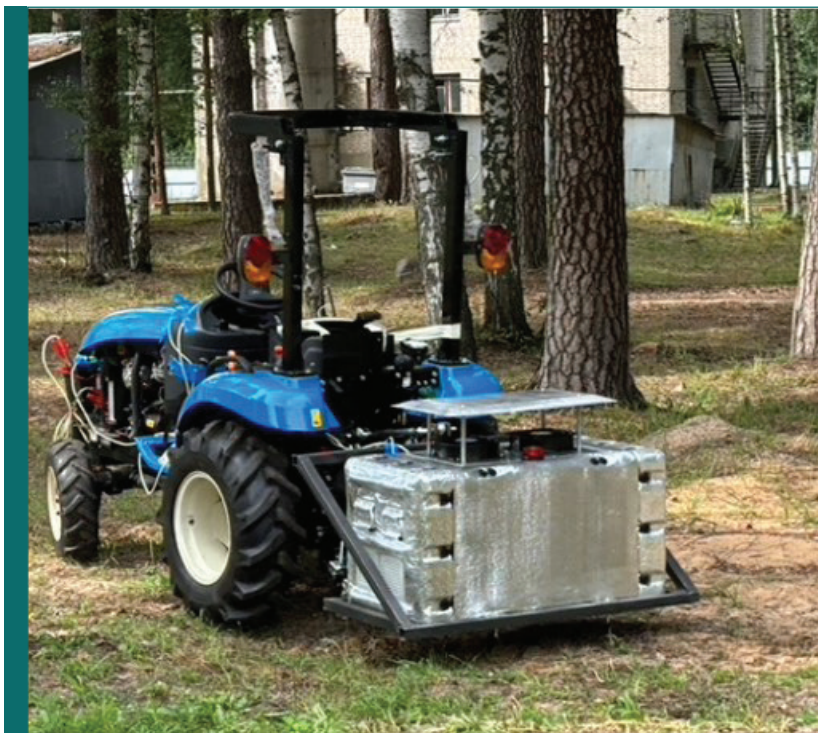
Сканер на основе меченых нейтронов (ЛНФ и «Диамант») на беспилотной транспортной платформе, созданной в университете «Дубна»
