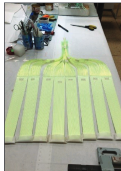
Слева: детектор АСТРА-М на спектрометре ФСД. Справа: внешний вид отдельных элементов детектора АСТРА-М. Элемент представляет собой пластину сцинтиллятора (\text{Ag})/{}^6\text{LiF} , которой придана форма поверхности временной фокусировки с наклеенными спектросмещающими волокнами, передающими поток света от места захвата нейтрона к ФЭУ
