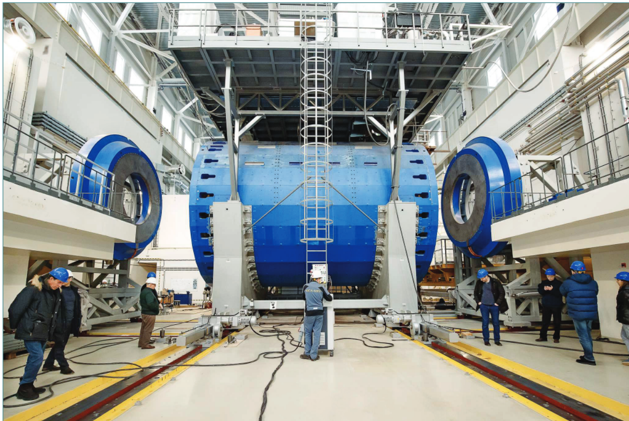
Технологическое перемещение 800-тонного соленоида детектора MPD
